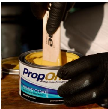
Miscelazione del Primer Coat
