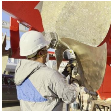
Préparation avec une meuleuse et brosse métallique
